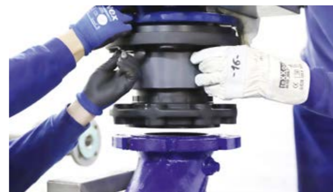
Abbildung 4 u. 5: Montage der Festflansch-Seite des Quick-Twist (l.) und Zustellung mittels einfacher Drehbewegung (r.) | Fotos: Reinert-Ritz
