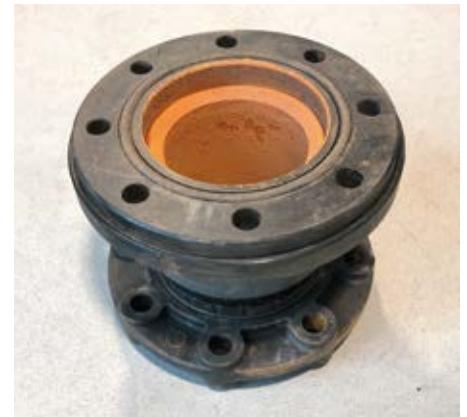
Abbildung 7: Ausgebautes Quick-Twist mit Ablagerungen (RWE Power, Tagebau Inden)
